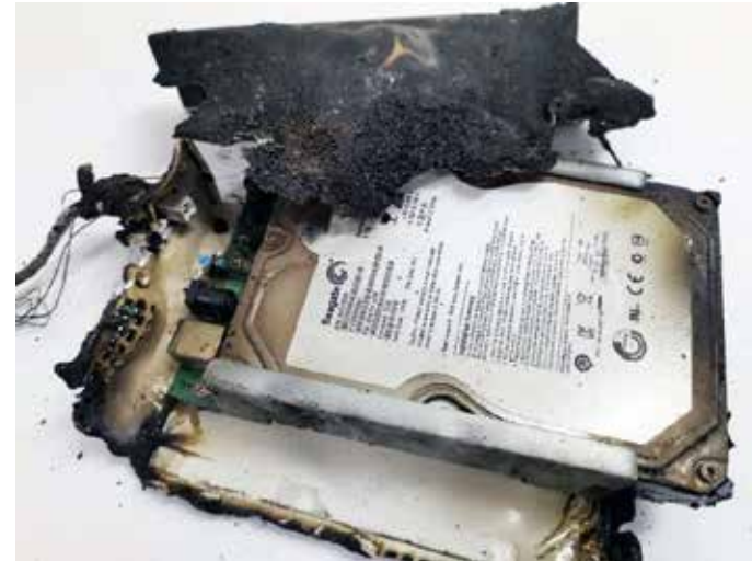
火災で融解したHDDの内部
