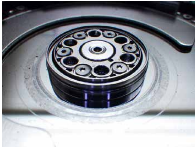
HDDの磁性体剥離の障害例
