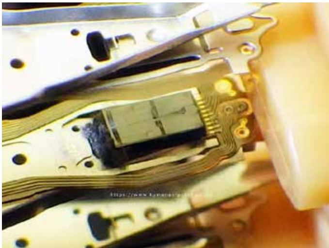
損傷したHDDの磁気ヘッドを拡大した様子
