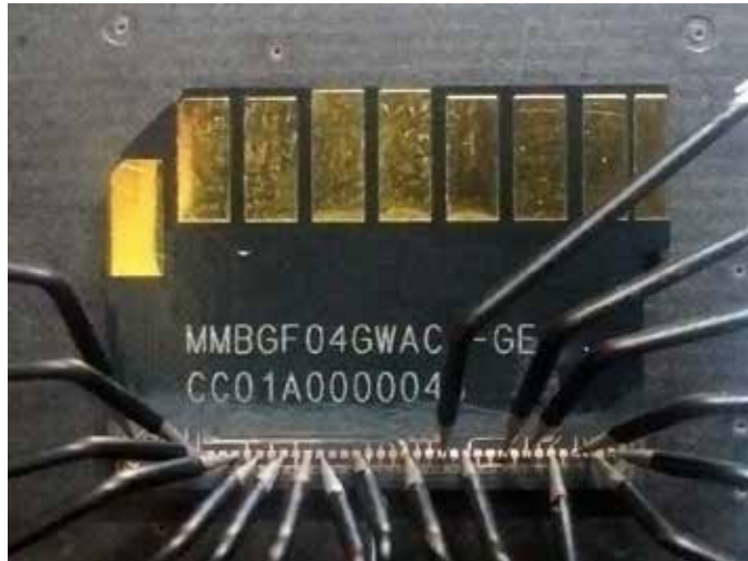
損傷したモノリスSDカード解析の様子
