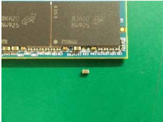
SSD回路のチップコンデンサ不良特定の様子
